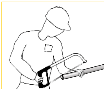
11 - Pas het laatste stuk aan door het versmalde overtollige gedeelte af te zagen.
