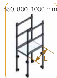
WV6240xxx Verbrede uitgang met afdaling van dakrand, breedte 650 mm, 800 mm & 1000 mm
