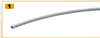
1 Stahlseil WVCI8 Edelstahl Ø8mm, 7x7 Innen mit Faserband für eine leichtere Nachverfolgung.
